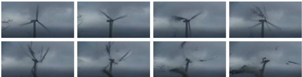
Rys. 1.36. Przypadek awarii katastrofalnej turbiny, możliwa jest obserwacja torów lotu fragmentów łopat (fragmenty materiału 211 )
